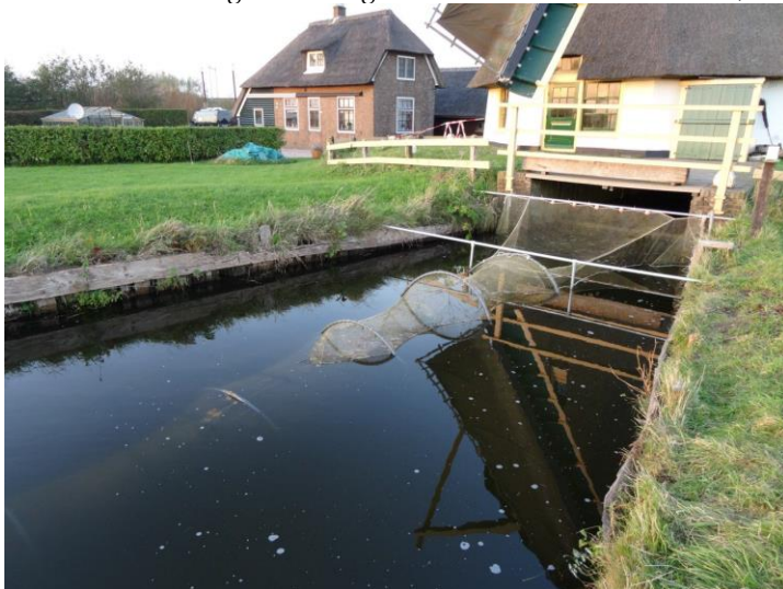
Figuur 3 Voorbeeld van gemaal fuik en gebruikt frame, locatie: molen de Onrust.
