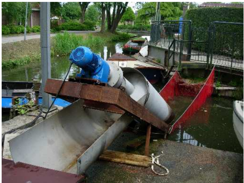
figuur 3.5 Netconstructie voor aanvoer van vissen naar de buisvizel
