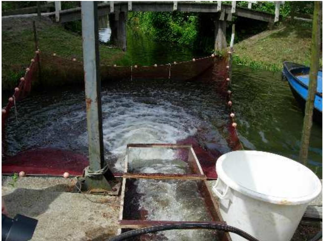
figuur 3.6 Netconstructie voor opvang van uitgemalen vissen
