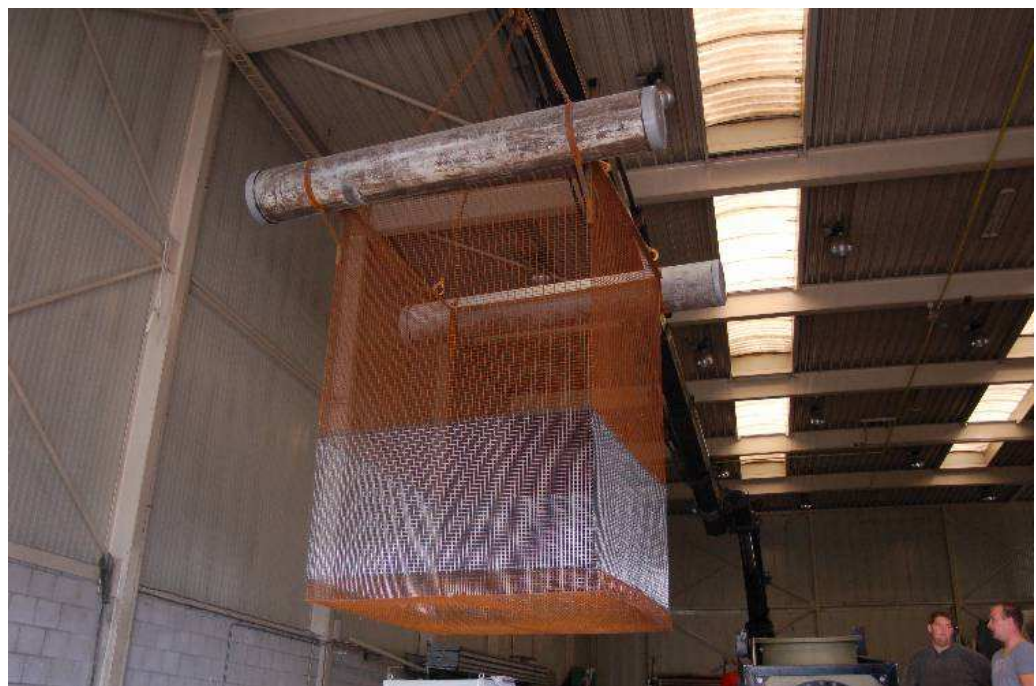
figuur 3.2 Kooi voor de aanvoer van vissen
