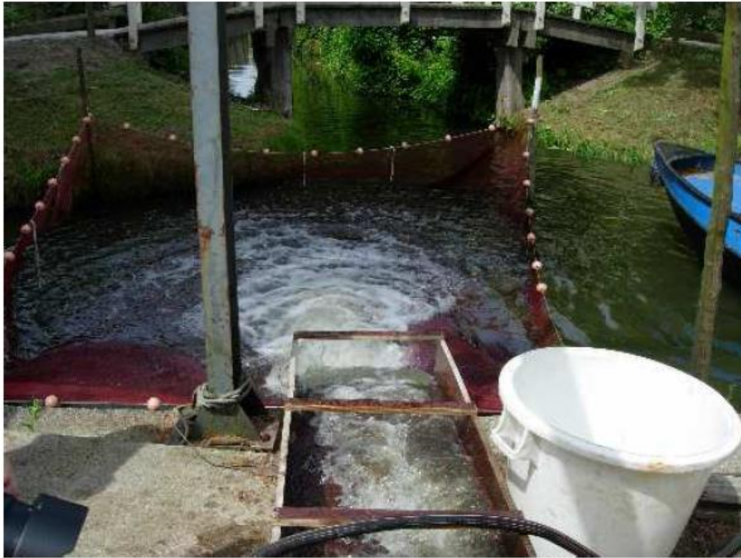
Figure 3.3 Netconstruction for collection uitgemalen fish
