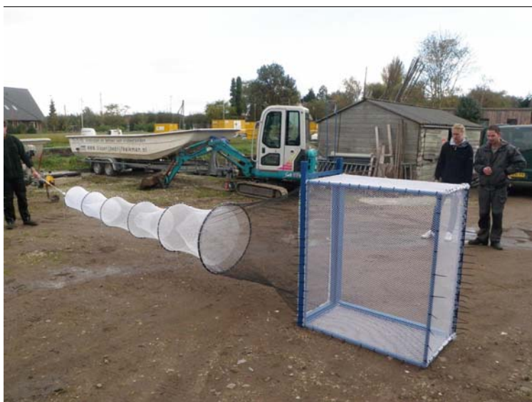
Figuur 2.5 De kanaalfuik; een hokfuik met frame voor de bemonstering van vismigratie in stroomafwaartse richting
