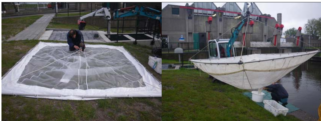
Figuur 2.6 Het kruisnet voor het bepalen van visaanbod bij gemaal Halfweg aan de kanaalzijde.
